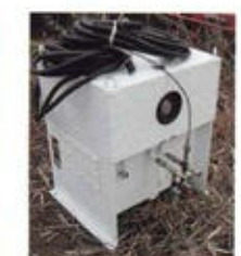
■油圧ポンプ 高圧で油を送り拡大ビットを開閉します。
