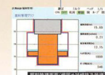
■掘削管理画面(掘削球根管理) 計測した油流量を拡大径に変換して表示し、あらかじめ設定しておいた計画掘削形状と比較してビジュアル的に施工管理を行います。
